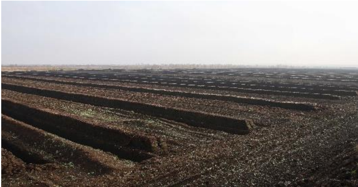
Offene Lagerung und Trocknung der abgefrästen Torfmengen (Drebbescher Moor). Foto: Dr. Matthias Schreiber
